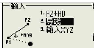
导线功能用来计算新点，这个新点的计算是基于二个已定义的点和角度以及到一条由这二个点所定义的直线的水平和垂直距离。
