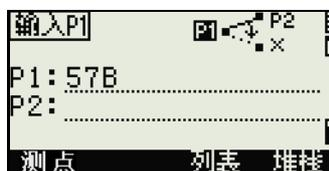
输入加减角度，输入到达一条由 P1-P2 定义的基线的水平距离和垂直距离。
