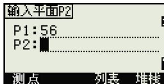
一旦定义了平面，已计算的测站和 dZ 值便随着望远镜的转动而更新。不需要距离测量。
