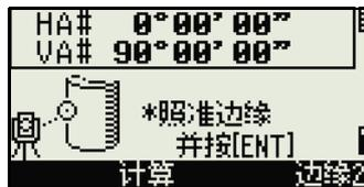
如果您已经对圆对象的中心进行了距离测量，按 **计算** 软功能键，用一个边缘角度观测值计算偏移量。
