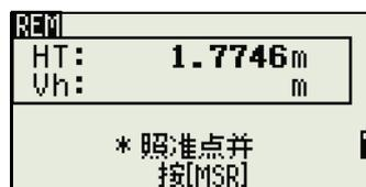
4. 拧松垂直制动钮，转动望远镜，使它瞄准任选点。
