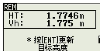
您可以用 REM 测量值更新目标高度。测量棱镜，应照准棱镜杆底部，并按 **[ENT]**。
