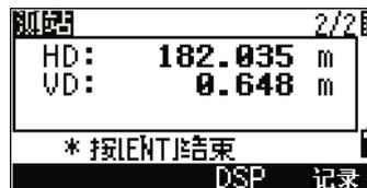
如果通过输入 P2 坐标的方法定义了直线, 在测量数据与输入坐标数据之间的 HD (dHD) 与 VD (dZ) 的差值便显示出来。
