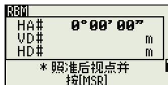
5. 要进行盘左 / 盘右测量，按 **F2** 软功能键，或在测量完距离之后，转动望远镜到盘右。
