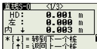
5. 用 **[^]** 或 **[v]** 改变导引点。您可以计算并导引两倍的放样数。
