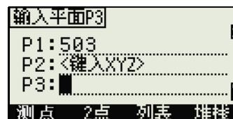
如果平面由二个点（通过选择 2 点）定义，垂直平面与用于 V 面功能中的平面相同，但显示系数是测站和 dZ，而不是 a 和 b。更多信息，请看“测量垂直面上的距离和偏移量值（第 103 页）”。
