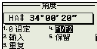
如果已经测量了目标的距离，可以把望远镜转到另一个盘，开始对盘左 / 盘右进行平均。
