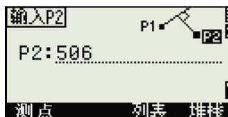
如果 P1 和 P2 是三维点，垂直点的 Z 坐标相对于 P1-P2 的斜坡被计算出来。
