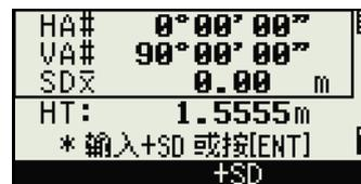
如果您把棱镜贴近圆对象表面进行距离测量，在按 **[ENT]** 之前先按 **+SD** 软功能键，以消除偏移量误差（从贴近点到已测棱镜表面）。
