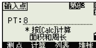
输入的的第一个点和最后一个点首尾相接，使面积闭合。
